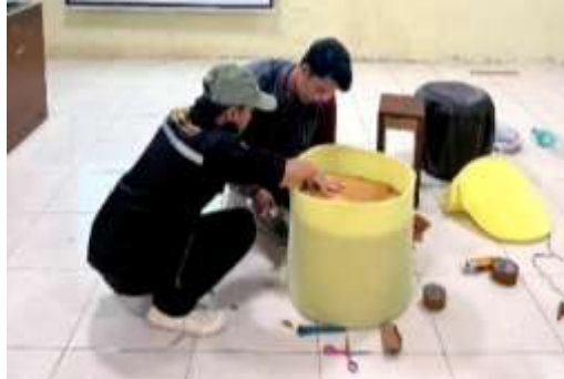
Gambar 5. Pemasangan Ecobrick ke Rangka Tempelkan susunan ecobrick di atas triplek alas dengan lem atau paku kecil.
