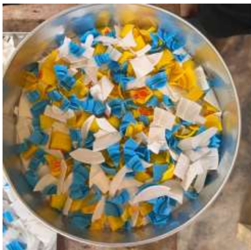
Gambar 3. Penyusunan tutup botol hasil cacahan sebelum masuk ke oven pembakaran
