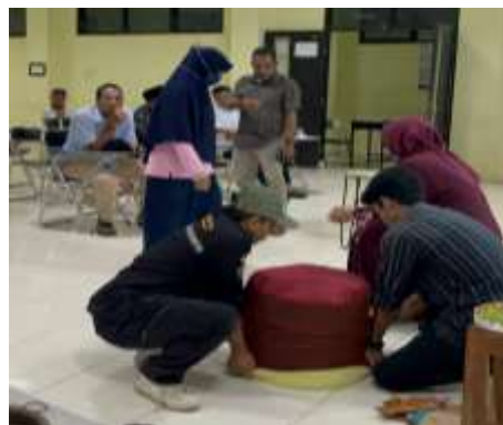
Gambar 6. Penutup Atas dan Finishing . Tempelkan busa pada triplek penutup, bungkus dengan kain pelapis, lalu pasang di atas ecobrick .
