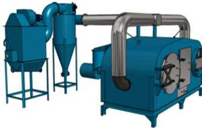
**Gambar 4.** Finalisasi teknologi pirolisis reaktor ganda dengan pencuci asap, (HKI Reaktor Ganda, 2024)
